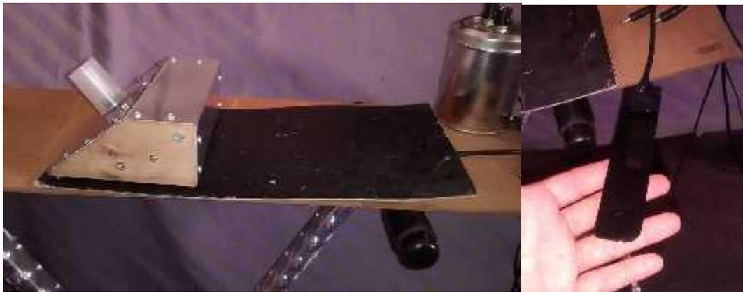
Figura 1. Dos cuerpos vibrantes sobre los que se probara el sistema.
