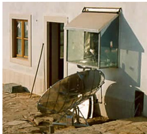
Figura 3: Modelo con reflector de 2 \text{ m}^2 en Portugal
