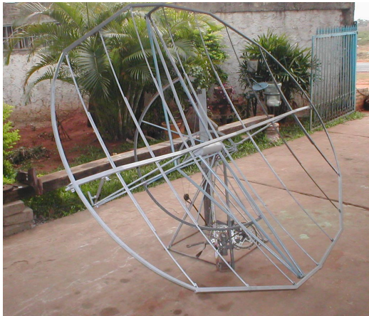
Figura 2: Estructura del reflector en construcción
