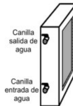
Figura 1. Esquema del colector-acumulador de agua compacto de 3000 cm 3 diseñado con fines didácticos.
