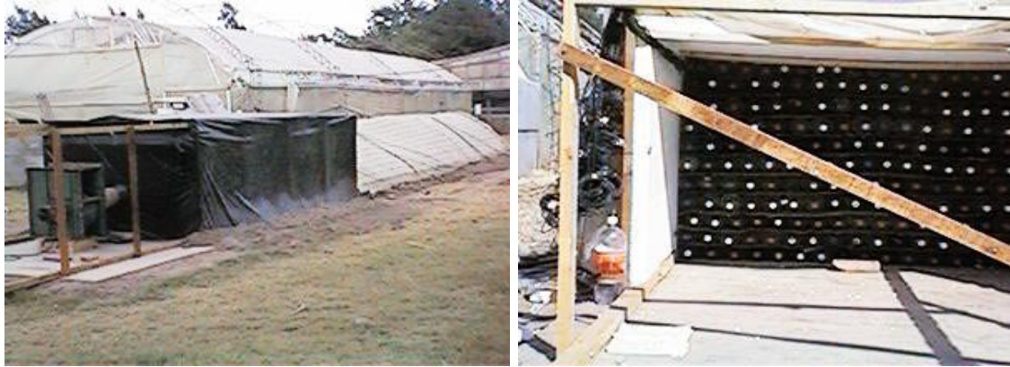
Fig. 4. Vista del colector de aire acoplado al lecho de agua e interior del mismo
