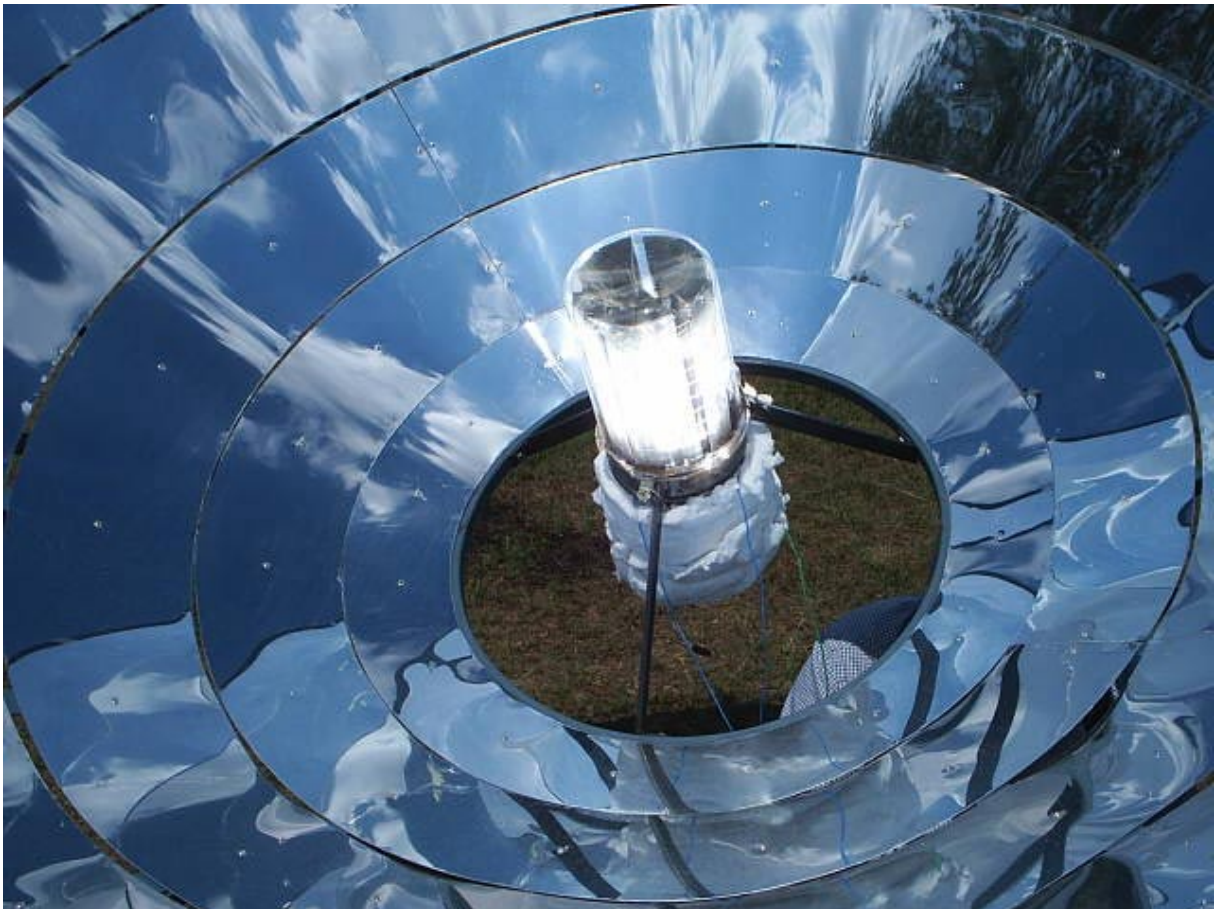
Figura 5: Foto del concentrador solar utilizado. Este ha sido diseñado para un absorbedor vertical de 20 cm de longitud.
