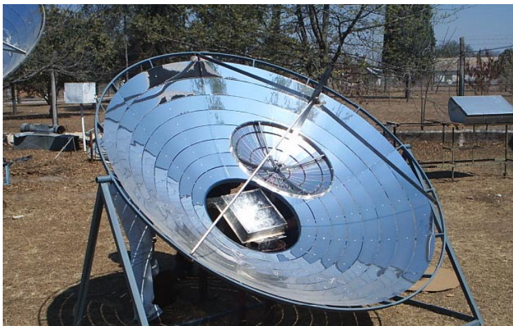
Fig. 3.- Muestra una foto del concentrador construido con los dos reflectores y su base. El absorbedor que se aprecia no es el definitivo.
