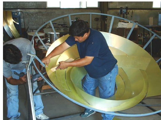
Fig. 2.- Muestra algunas de las etapas constructivas: la estructura soporte con su aro central, sus brazos y, el corte de los aros y la colocación fina de los aros de lámina de aluminio reflejante.
