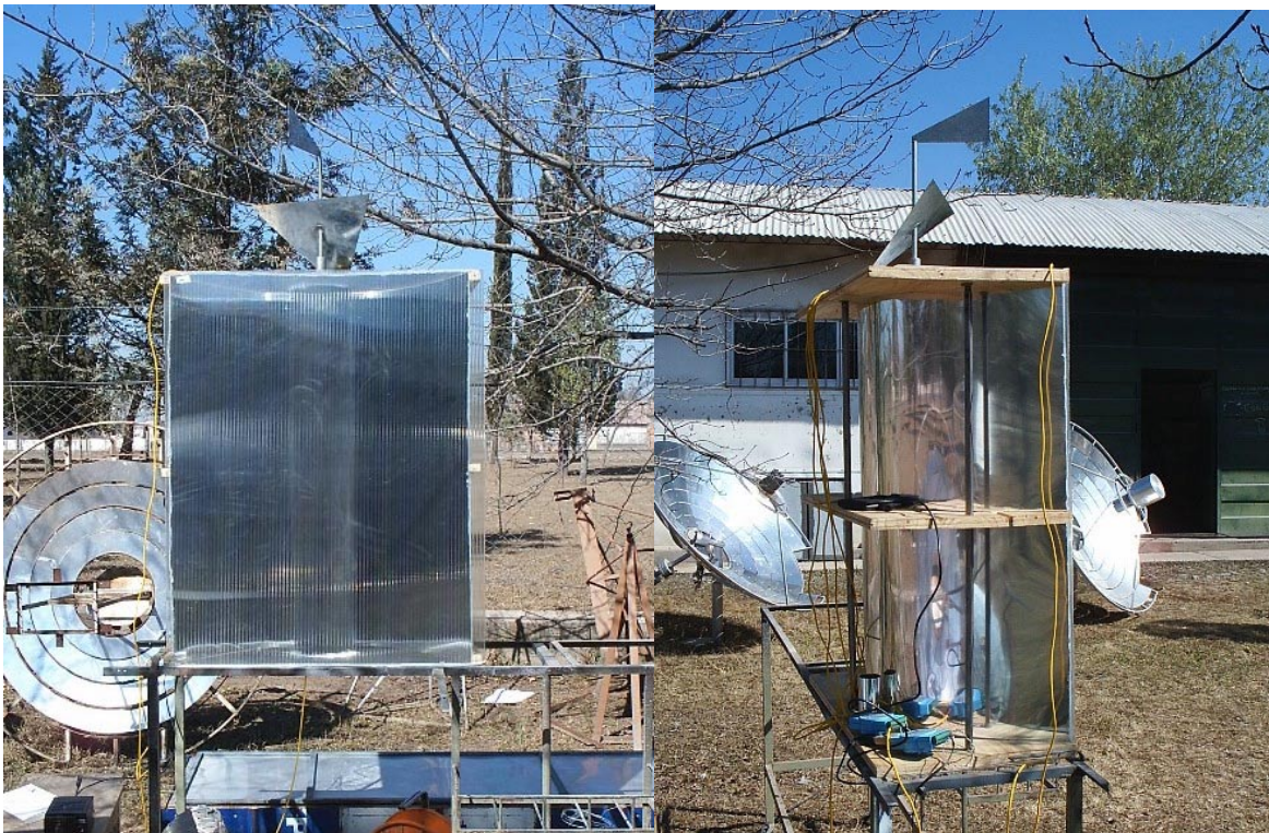
Figura 1: Izquierda: foto de frente de la chimenea concentrador solar. En la parte superior se observa el extractor eólico tipo delta invertido. Derecha: foto con la vista lateral derecha. Se observa también el equipo de medición utilizado.
