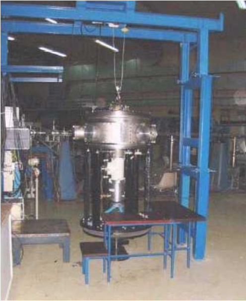
Figura 1: Fotografía de la cámara de ensayos.
