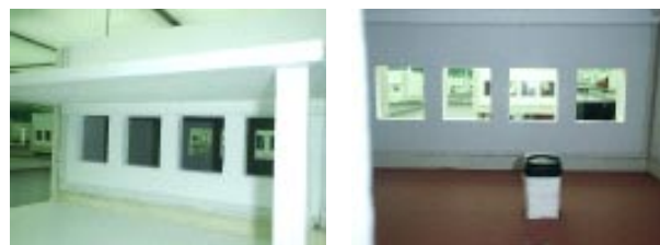
Figura 4: Modelo a escala construido para mediciones en el Cielo Artificial: Foto1: vista de la galería, Foto2: Ubicación de Luxímetro.
