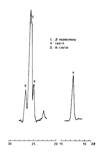
Difractograma de una muestra de espodumeno que ha sufrido el proceso de transformación. En la misma se observa la superposición de los picos de cuarzo y caolín sobre el de espodumeno. Además se aprecia el
