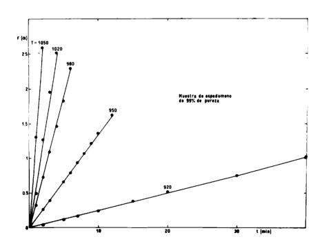
Fig. 19: Representación de K vs. tiempo de calentamiento.
