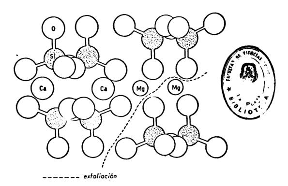
Fig. 2: Estructura del diópsido. Indicación del transcurso de la exfoliación que deja intactos los enlaces Si-O.
