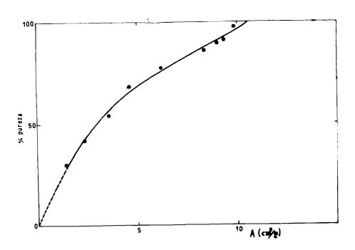
Fig. 11: Curva de calibración correspondiente al mineral espodumeno, para el cálculo de ΔH de transformación correspondiente a una muestra de 100 % de pureza. La curva es válida para la evaluación de muestras con contenidos desconocidos de mineral.
