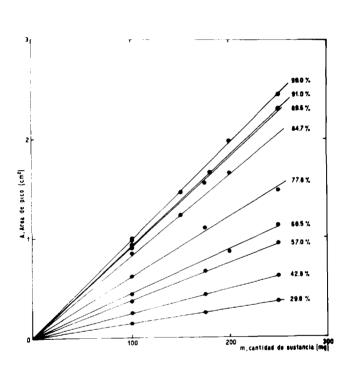
Fig. 10: Representación de áreas de pico (cm²) en función de cantidad de sustancia (mg), para muestras de diferente pureza en espodumeno.
