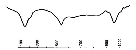
Fig. 5: Termograma correspondiente a una muestra original de espodumeno I.
