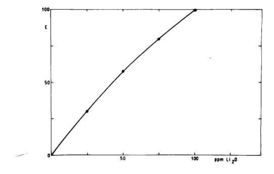
Curva de calibración del espectrofotómetro Jarrell-Ash para la determinación de litio, en la que se representan lectura de emisión en función de la concentración en ppm de Li<sub>2</sub>O.
