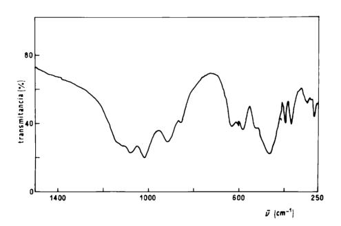
Fig. 6: Espectro de IR de la forma I del espodumeno.
