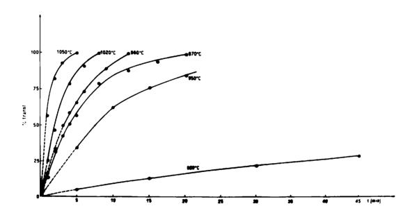
Fig. 14: % de transformación vs. tiempo de calentamiento para espodumeno de 99% de pureza.
