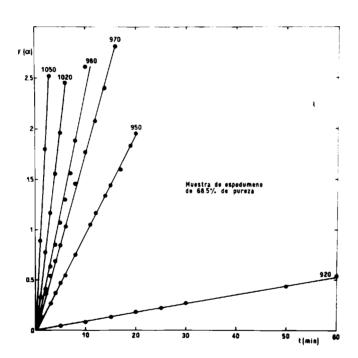
Fig. 18:  $F(A) = \ln (1-A)$  en función de tiemp tiempo de calentamiento para muestras de espodumeno de 99 % de pureza.
