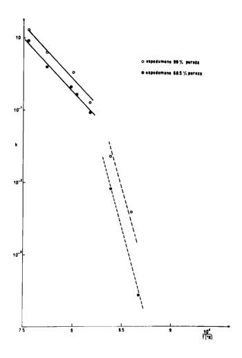
Fig. 20: Aplicación de la ecuación de Arrhenius para el cálculo de la energía de activación del proceso.
