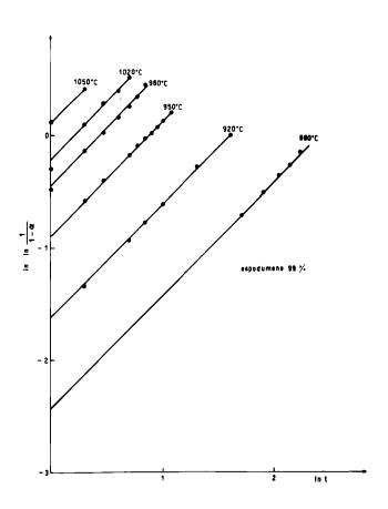
Fig. 15: Representación de ln  $(\ln \frac{1}{1-\alpha})$  vs. ln t para el cálculo de  $\alpha$  y K, para la muestra de espodumeno de 99 % de pure za.
