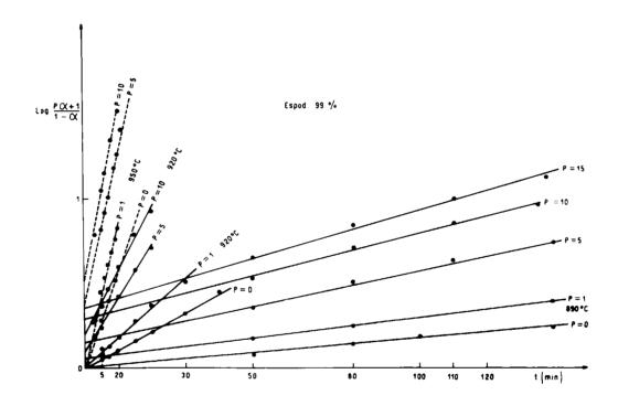
El valor de la energía de activación, obtenido al representar log C en función de l/T, se obtuvo trazando una línea tal que uniera los puntos de mínimo valor de P, a partir del punto correspondiente a una temperatura igual a 950°C, donde no existe inducción, y por lo tanto P vale cero.
