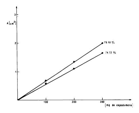
Representación de área de pico (cm<sup>2</sup>) en función de cantidad de sustancia para muestras de espodumeno utilizadas para corroborar los datos de la curva de calibración de la figura 11.
