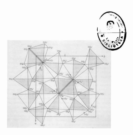
Fig. 3: Proyección de la estructura de LiAlSi<sub>2</sub>0<sub>6</sub> II, bajo el eje c.
