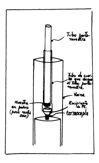
Fig. 12: Esquema del tubo del horno y accesorios para efectuar calentamientos en forma estática.
