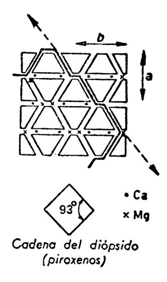
Fig. 1: Transcurso de la exfoliación del diópsido, como ejemplo para piroxenos. Simétricamente a la dirección de exfoliación indicada hay una segunda dirección cuyo transcurso está indicado por la línea, que en la parte inferior señala hacia la izquierda.
