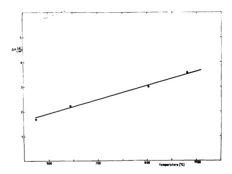
fig. 9: Curva de calibración para ATD de  $\Delta$  H (cal/cm²) en función de temperaturas de reacción.
