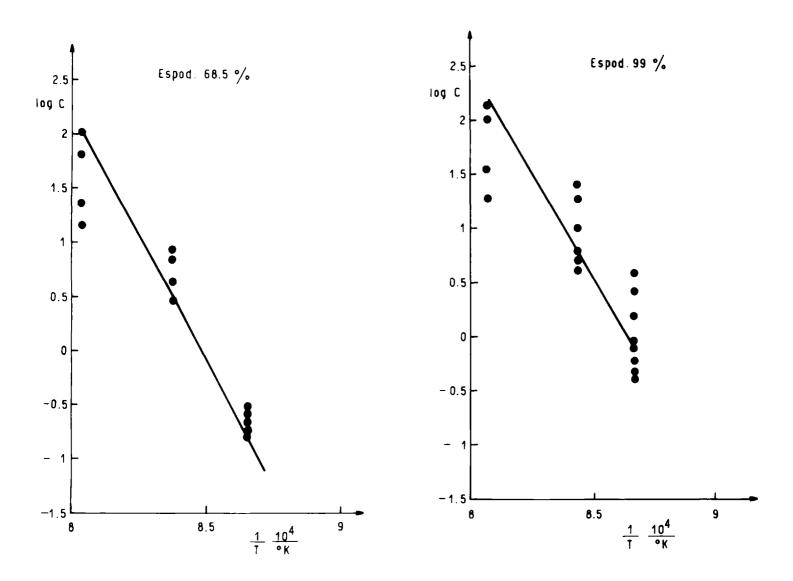
Fig. 22: Representación de log C vs. 1/T para el cálculo de la energía de activación.
