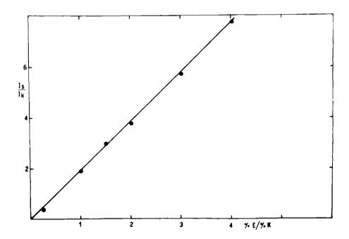
Curva de calibración para la determina ción cuantitativa de espodumeno II. En la misma se representa la relación entre las intensidades de las líneas de espodumeno y caolín, y la relación entre % de mineral estudiado y % de patrón interno.
