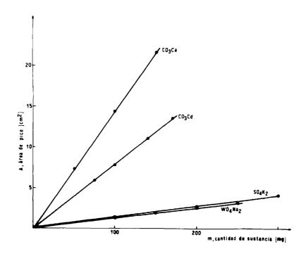
Fig. 8: Representación del área de pico en cm², en función de la cantidad de muestra usada en mg, para las siguientes sustancias:  $Na_2WO_4$ ,  $K_2SO_4$ ,  $CaCO_3$ ,  $CdCO_3$ .
