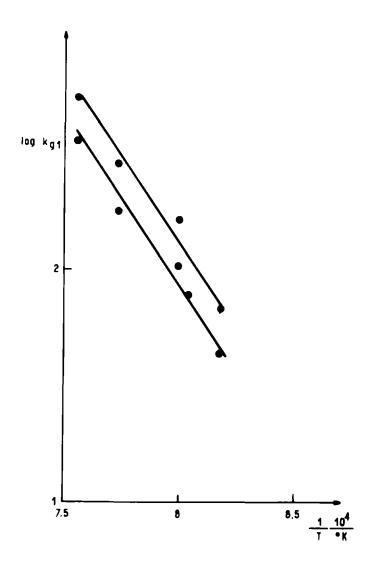
Fig. 26: Representación de  $\log k_{g_1}$  en función de 1/T para el cálculo de la energía de activación.
