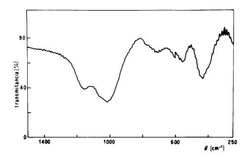
Fig. 7: Espectro de IR de la forma II del espodumeno.
