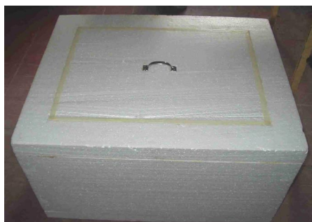
Foto 1. Caja Caliente cerrada
