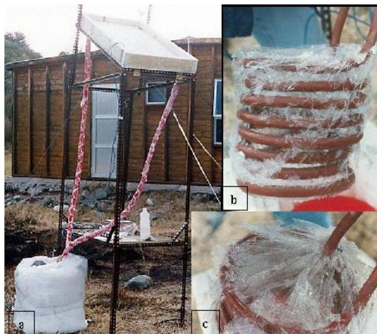
Figura 5: Equipo armado sobre su soporte y hielo formado con él.
