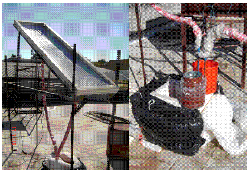
Figura 4: Equipo armado sobre su soporte y conservadora desarmada.
