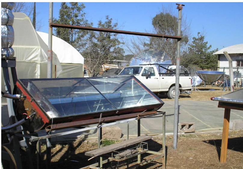
Figura 4: Vista del CPC durante el ensayo
