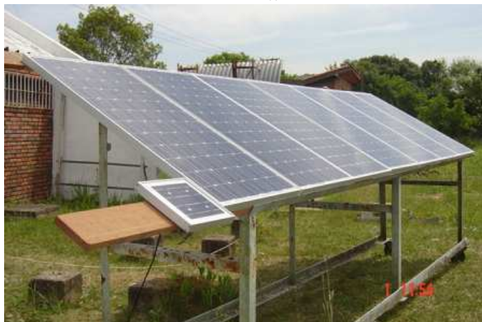
Figura 3: Módulos fotovoltaicos siendo ensayados
