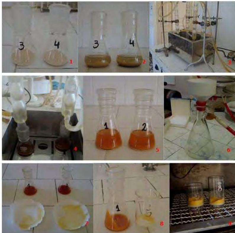
Figura 5. Procedimiento aplicado para la determinación del contenido de celulosa. Foto 1: muestras de aserrín libres de extraíbles. Foto 2: muestras con ácido nítrico – etanol (1:4). Fotos 3, 4: aserrín más mezcla reactiva a reflujo en baño María. Foto 5: decantación de la muestra. Fotos 6, 7: embudo Buchner, kitasato y papel utilizado para el filtrado del sobrenadante, para los tres primeros filtrados de la muestra con bomba de vacío. Foto 8: residuo obtenido luego del cuarto filtrado del líquido sobrenadante con crisol filtrante. Foto 9: residuo –celulosa- seca en estufa.
