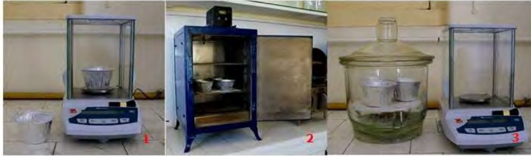
Figura 2. Procedimiento aplicado para la determinación del contenido de humedad de las muestras. Foto 1: obtención del peso seco al aire del material. Foto 2: colocación de las muestras en estufa. Foto 3: determinación del peso seco de la madera.
