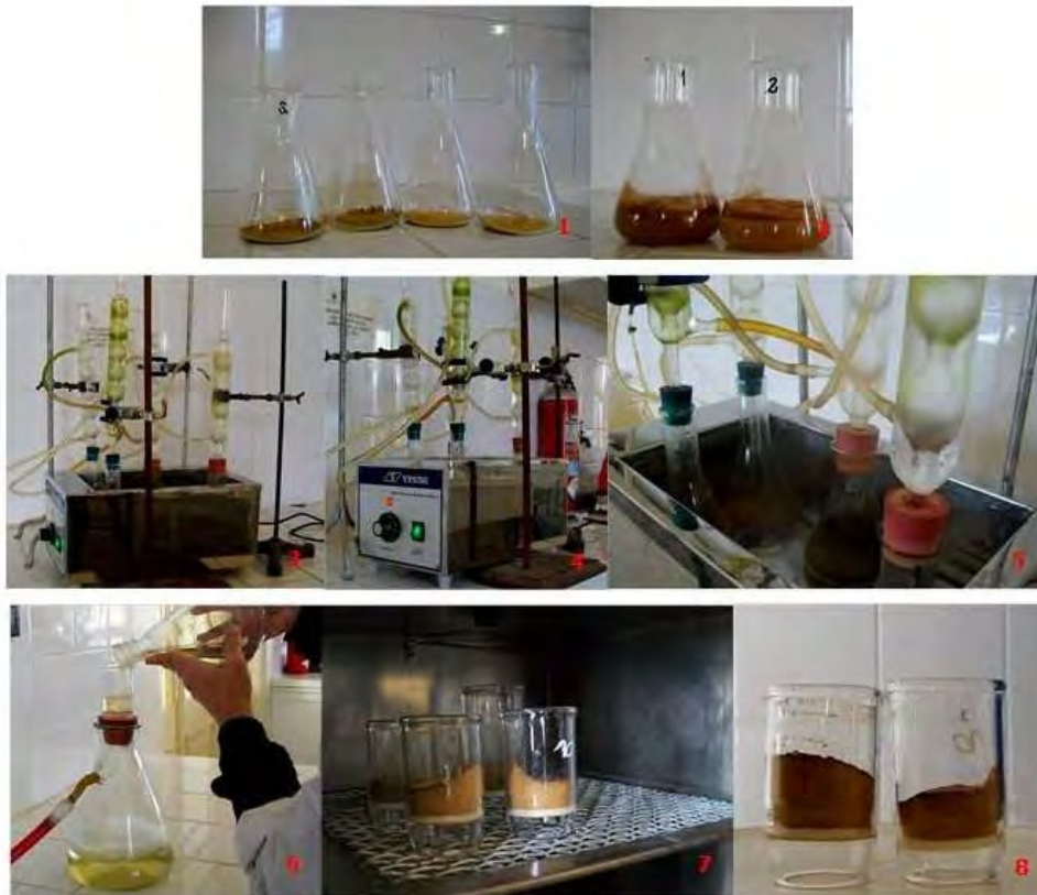
Figura 4. Secuencia aplicada para la determinación de extraíbles en agua caliente. Foto 1: muestra de aserrín empleado. Foto 2: aserrín más 100 ml de agua destilada. Fotos 3 a 5: muestras colocadas en condensador a reflujo y expuestas a baño de agua a ebullición. Foto 6: filtrado; decantación del líquido sobrenadante con bomba de vacío. Fotos 7, 8: residuo obtenido seco en estufa a 105 °C hasta peso constante.
