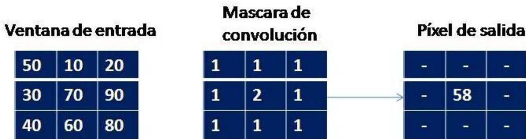
Figura 10. Ejemplo del algoritmo de la convolución
