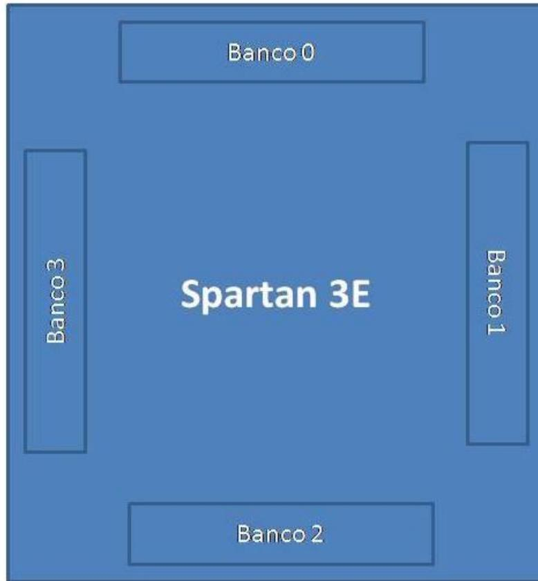
Figura 49. Distribución de los bancos de entrada/salida en una FPGA Spartan3E de Xilinx
