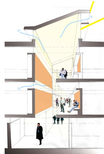
Figura 16. Sección, luz y ventilación natural
