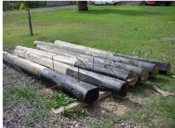
Figura 2: palos (columnas) con hierro de 8 mm.
