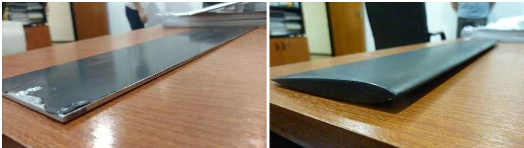
Figura 2.4. Modelos Alares utilizados. En la izquierda placa plana, en la derecha perfil SD8020
