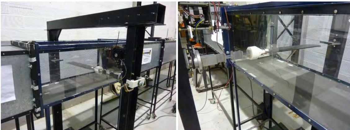
**Figura 2.1. Pórtico y túnel de viento en la izquierda. Detalle del mecanismo de movimiento en la derecha.**
