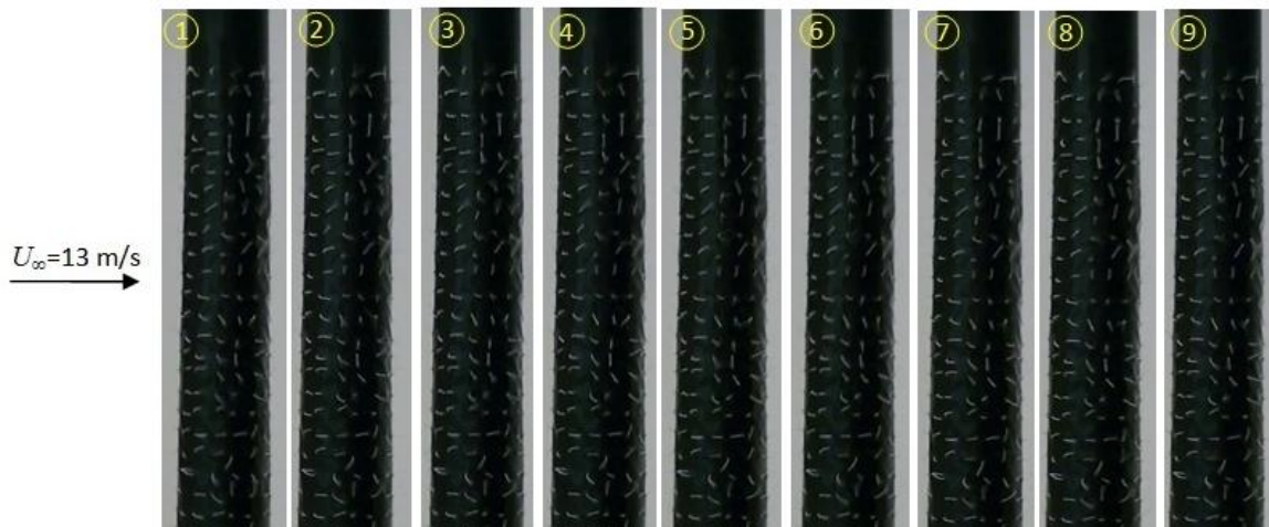
Fig. 6.24: Visualización con catavientos para flujo incidente de 13 m/s. ( Re = 3,8 \times 10^4 basado en el diámetro medio). El tiempo entre cada fotograma es 0,02 s.
