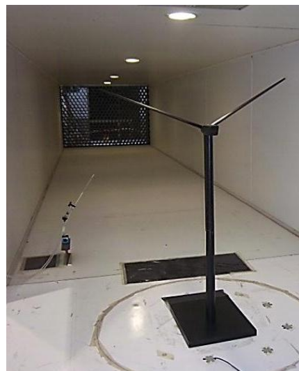
Fig. 6.3: Modelo montado en el túnel de viento
