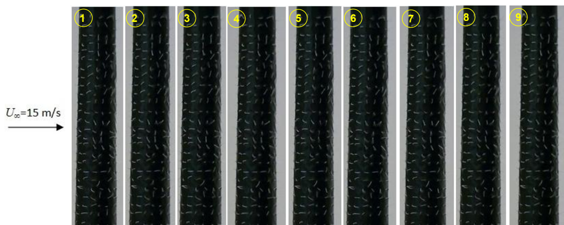
Fig. 6.25: Visualización con catavientos para flujo incidente de 15 m/s. ( Re = 4,4 \times 10^4 basado en el diámetro medio). El tiempo entre cada fotograma es 0,02 s.
