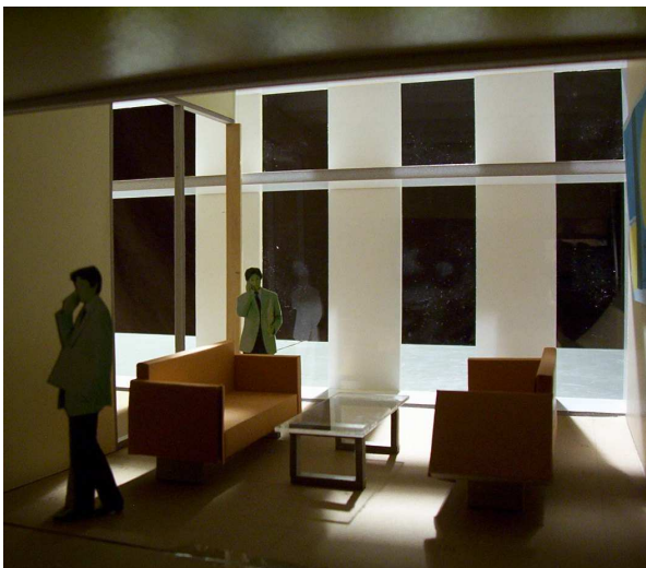
Figura 5. Estudio de iluminación natural con maqueta del estar en heliodón y el cielo artificial: fotografía que indica el nivel y la distribución de luz en días de cielo claro y con cielo nublado, con luz difusa, en el interior del estar de mayor altura con techo de hormigón con elementos prefabricados.
