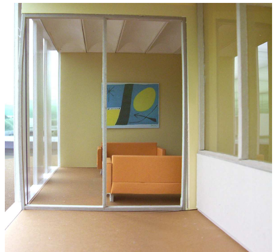
Figura 5. Estudio de iluminación natural con maqueta del estar en heliodón y el cielo artificial: fotografía que indica el nivel y la distribución de luz en días de cielo claro y con cielo nublado, con luz difusa, en el interior del estar de mayor altura con techo de hormigón con elementos prefabricados.
