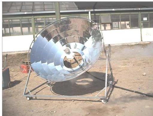
Fig.2. Vista de frente del concentrador parabólico con la caldera en el foco
