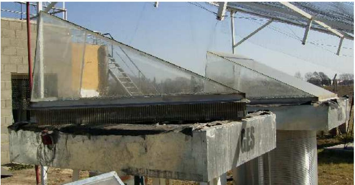
*Figura 5. Vista de las cubiertas vidriadas desmontables. Se aprecia en primer plano al destilador básico con su cubierta removida y cruzada sobre la batea del mismo. En segundo plano el destilador con Acumulador con la cubierta en posición de trabajo.*
