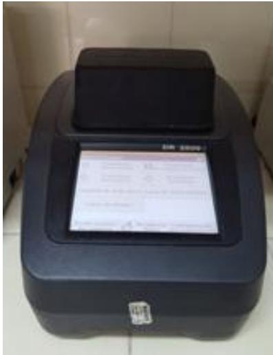
**Figura 2.6. Espectrofotómetro Hach DR 2800**
