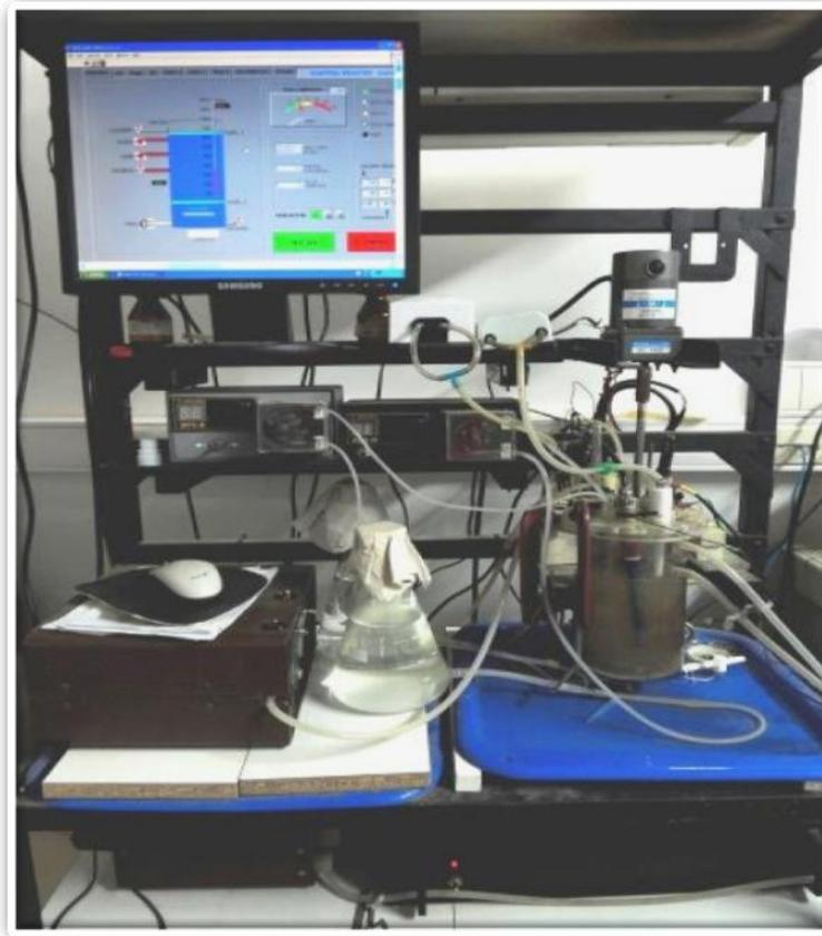
**Figura 2.1. Reactor de cargas secuenciales (SBR)**
