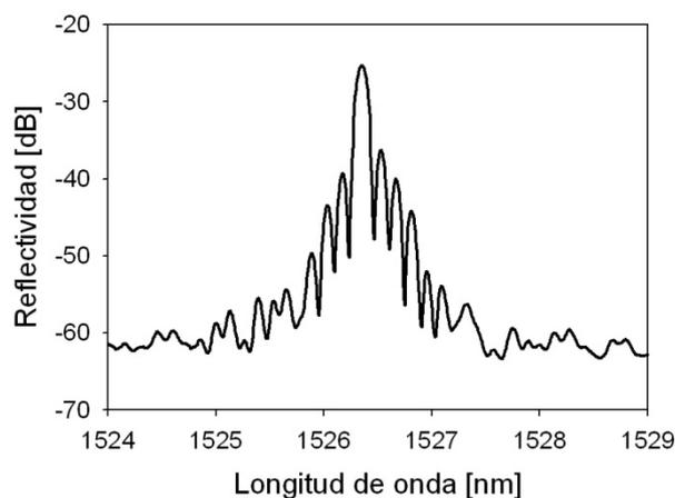
Fig. 4: Espectro de reflexión con lóbulos laterales
