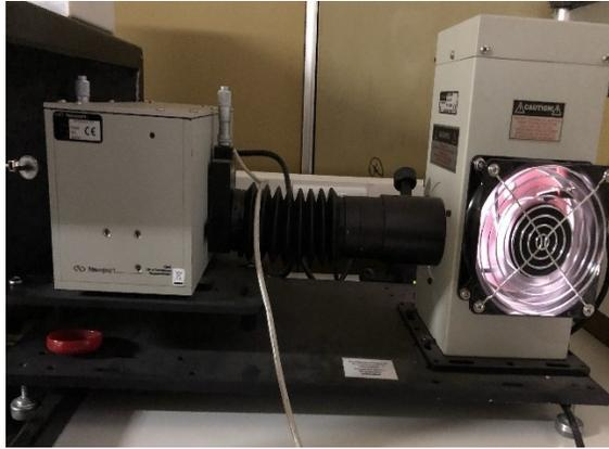
**Figura 5.3.** Sistema de Irradiación III, compuesto por una lámpara de Xenón (300W) acoplada a un monocromador motorizado UV-VIS.
