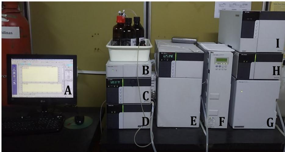
**Figura 7.1.** Fotografía del equipo *Shimadzu Prominence LC-20A*. A: computadora y *software* para el análisis de los datos (*LC Solution*), B: desgasificador, C: módulo de distribución de disolventes, D: módulo controlador, E: inyector automático, F: horno y columna, G: colector de muestras, H: detector UV/Vis (PDA), I: detector de fluorescencia (FL).
