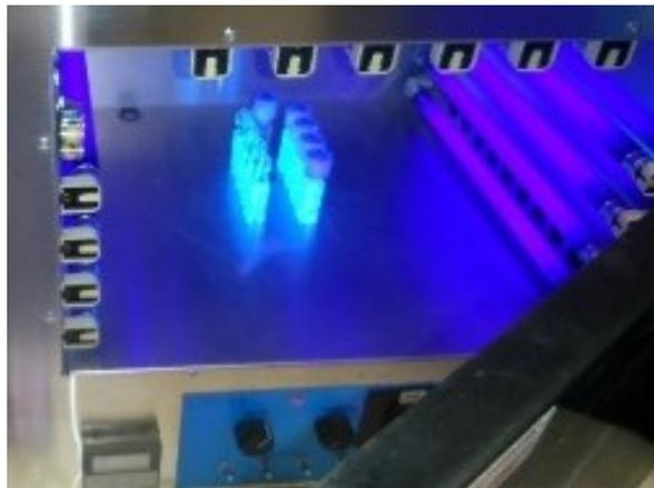
**Figura 5.4.** Sistema de Irradiación IV, provisto de 12 lámparas (Osram Sylvania, F15T8/BLB) colocadas dentro de un fotorreactor.
