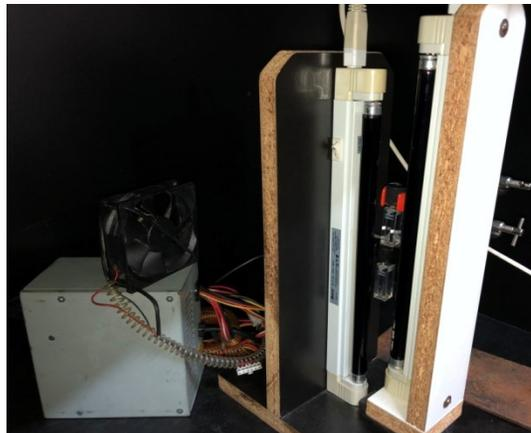
**Figura 5.2.** *Sistema de Irradiación II*, provisto de dos lámparas Rayonet RPR 3500 y celdas de cuarzo fluorescencia colocadas entre las dos lámparas.
