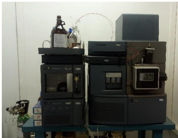
**Figura 7.2.** Fotografía del equipo UPLC-QToF-MS.
