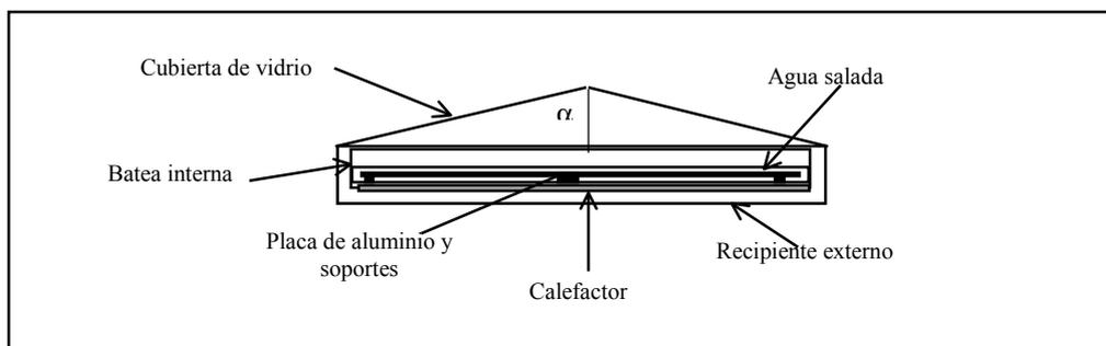
Figura 1. Esquema del destilador empleado en laboratorio.
