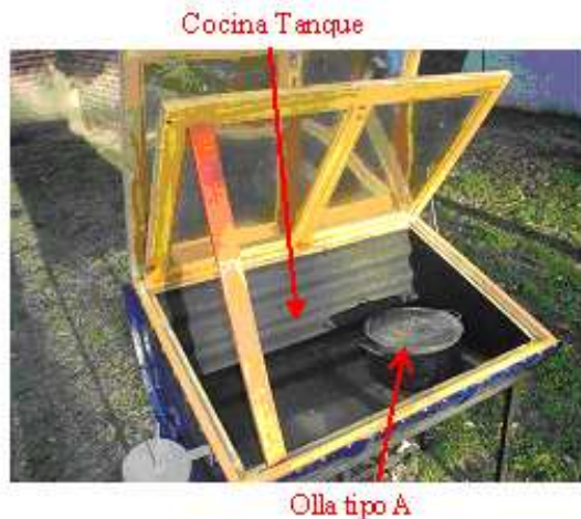
Figura 1a. Vista de la Cocina Tanque con olla de referencia
