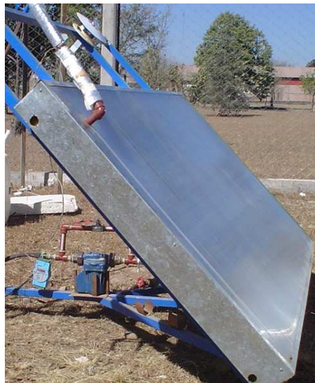
Figura 4. Vista del colector de bolsa de PVC y del banco experimental
