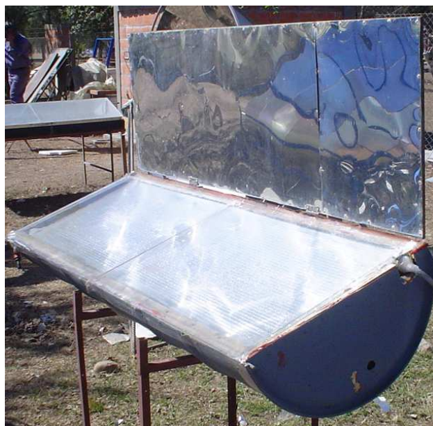
Figura 2. Calefón solar con placa colectora de policarbonato alveolar
