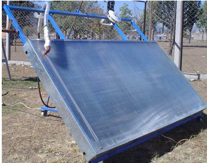
Figura 3. Vista del colector de bolsa de PVC y del banco experimental
