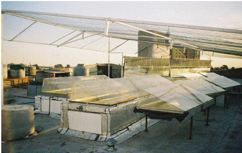
Figura 3 Fotografía de la pequeña planta experimental de destilación solar
