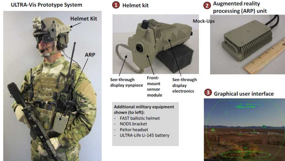
Figura 4.2 – Componentes del prototipo ULTRA-Vis (fuente: Roberts, R. et al [53])
