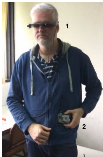
Figura 7.20 – Ejemplo de la Arquitectura propuesta utilizando gafas de RA (1) y ODROID XU3 (2) (fuente: propia)
