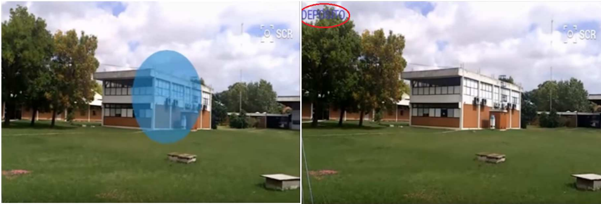
Figura 8.6 – Prueba de extracción de características utilizando ORB. Reconocimiento y Clasificación de objetos edilicios (fuente: propia)
