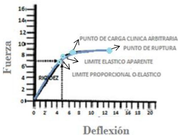
En el gráfico 6, se observa que el límite elástico aparente se denominará punto de resistencia y el punto de carga clínica arbitraria, punto de resistencia final a la tensión, que indicara la máxima carga que un alambre podrá soportar y, al mismo tiempo la fuerza máxima que podrá producir.
