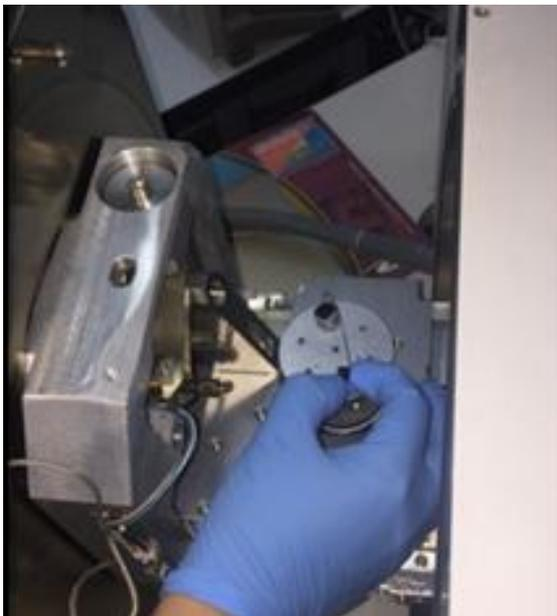
Figura 8.15: Fuente primaria: Montaje del arco nuevo en la platina del MEB.
