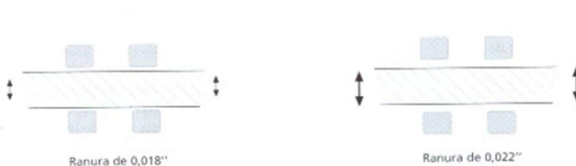
Figura 4.13 Fuente secundaria: Mc. Laughlin R, P. Bennet John C, Trevisi H J; Mecánica sistematizada del tratamiento ortodóncico. Página 14. El slot o ranura de 0.022" permite una mayor libertad de movimiento a los arcos iniciales y facilita mantener las fuerzas ligeras. <sup>24</sup>
