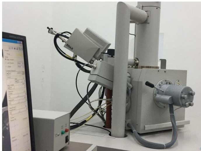
Figura 8.10: Fuente primaria Microscopio Electrónico de barrido del LIMF Quanta 200.
