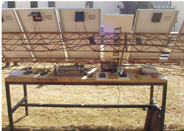
Figura 1: Fotografía del sistema manual de toma de datos con carga resistiva
