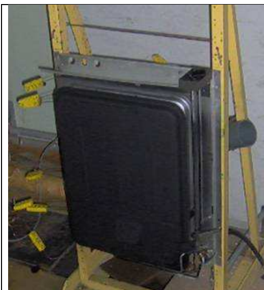
Figura 1a): Cámara del calefactor recubierta con pintura de alta temperatura color negro, y sistema de termocuplas.
