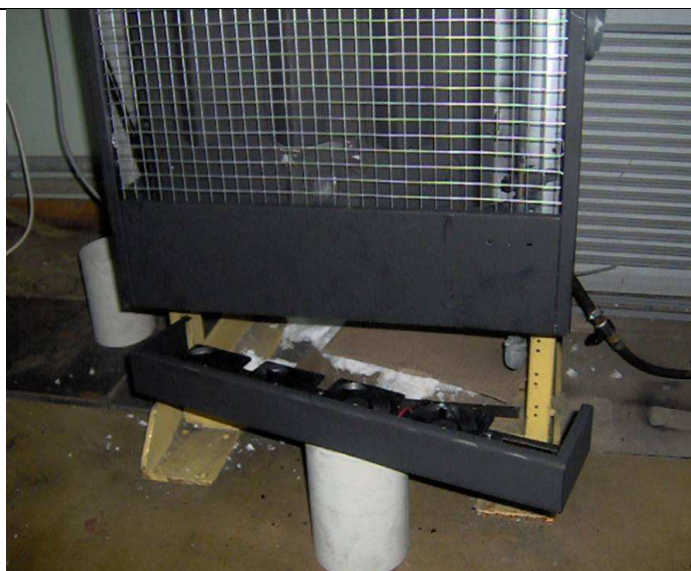
Figura 1b): Detalle del montaje de cuatro ventiladores para la convección forzada, y parte inferior del gabinete modificado.
