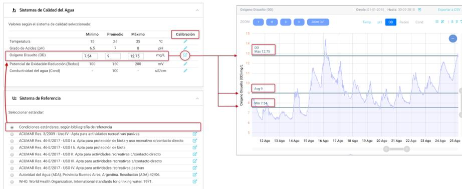
Fig. 5. Ejemplo de visualización y calibración de los umbrales en la variable “Oxígeno Disuelto”.
