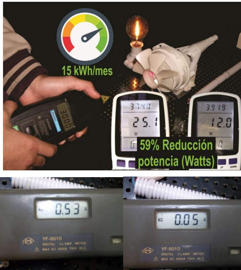
Figura 16 (A), (B) y (C). Cuando la eco-turbina trabaja a máxima potencia (Triac apagado), el vatímetro registra su valor más elevado -25.1 (W)- y la pinza amperimétrica evidencia el mayor consumo -0.53 (A)-, siendo la velocidad angular verificada por el fototacómetro laser equivalente a 3000 (RPM). En el otro caso, cuando la eco-turbina trabaja a mínima potencia (Triac encendido en el mayor grado de disparo), el vatímetro registra su valor más bajo -12 (W)- y la pinza amperimétrica evidencia el menor consumo -0.05 (A)-, siendo constante la velocidad angular verificada por el fototacómetro: 3000 (RPM). Valores TRUE RMS de potencia (vatios) e intensidad de la corriente eléctrica (amperios). Fuente: elaboración propia. Arriba foto tacómetro laser y vatímetro, abajo a la izquierda la pinza amperimétrica (True RMS) indica un consumo de 0.53 (Amperios) y abajo a la derecha la pinza amperimétrica indica un consumo de 0.05 (Amperios), lo cual significa una reducción de un 90% de la intensidad de la corriente eléctrica. / Figure 16 (A), (B) and (C). When the eco-turbine works at maximum power (Triac off), the wattmeter registers its highest value - 25.1 (W) - and the clamp meter shows the highest consumption -0.53 (A) -, being the angular velocity verified by the phototachometer laser equivalent to 3000 (RPM). In the other case, when the eco-turbine works at minimum power (Triac on in the highest degree of trip), the wattmeter registers its lowest value -12 (W) - and the clamp meter shows the lowest consumption -0.05 (A) -, being constant the angular speed verified by the photo-tachometer: 3000 (RPM). TRUE RMS values of power (watts) and current intensity (amps). Source: self made. Top photo laser tachometer and wattmeter, down to the left the clamp meter (True RMS) indicates a consumption of 0.53 (Amperes) and below to the right the clamp meter indicates a consumption of 0.05 (Amperes), which means a reduction of 90% of the intensity of the electric current.
