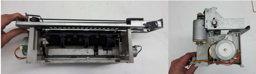
Figura 2. Estructura y paquete electromecánico reciclado de impresora inkjet Figure 2. Structure and recycled electromechanical package of inkjet printer
