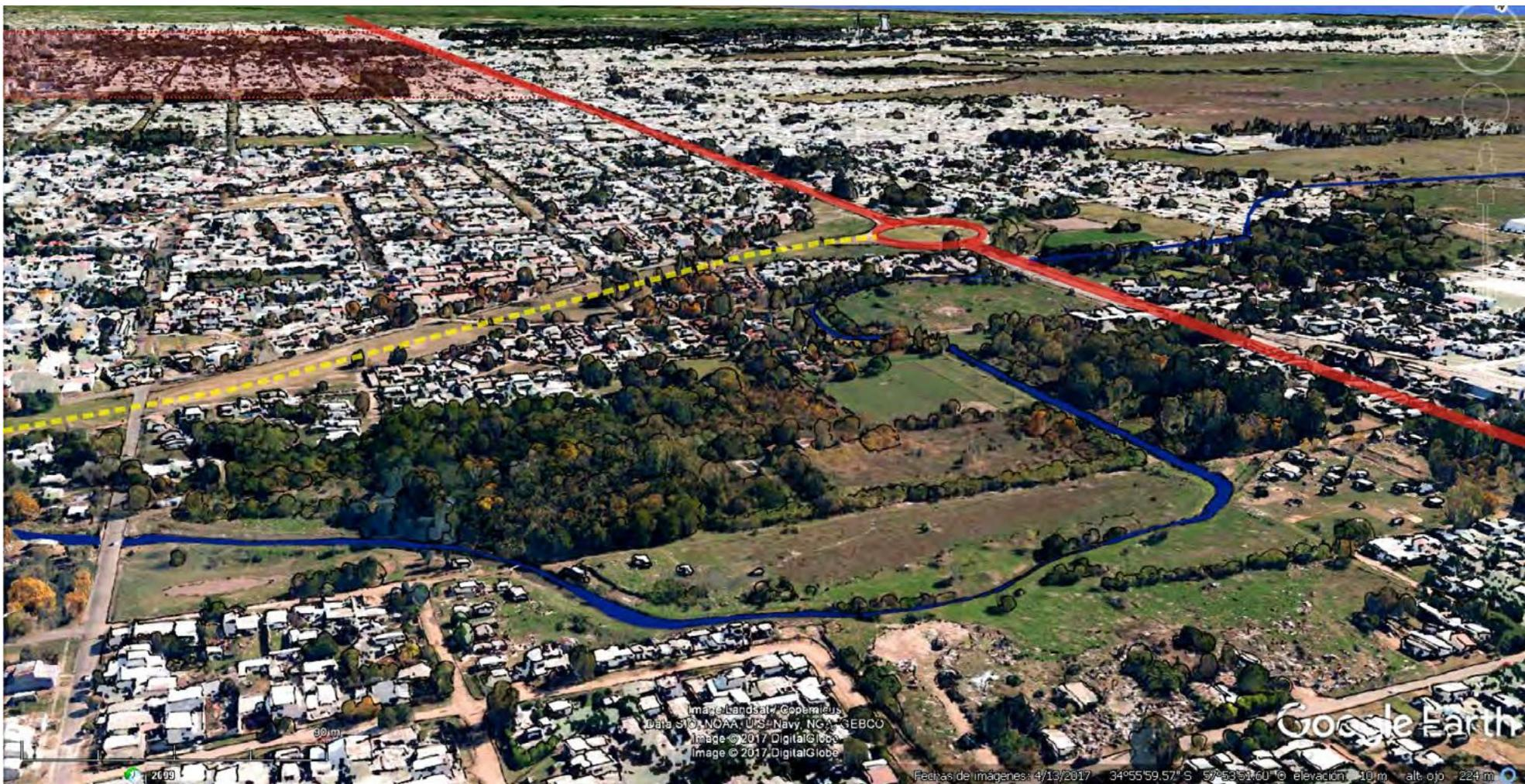
Los excedentes hídricos generados en la cuenca y subcuencas de aporte son conducidos hacia una zona de bañados naturales por una red no muy densificada de conductos y canales naturales y artificiales; un canal lateral, paralelo a la avenida 66, colecta las aguas y las conduce a su destino final en el cauce del Río de la Plata.
