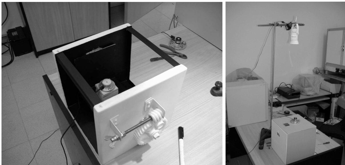
Figura 2: (Izquierda) Aspecto del dispositivo diseñado para realizar las experiencias en ausencia de los laterales y la cara superior. (Derecha) Montaje de la lámpara dicróica y el piranómetro testigo. Se puede observar la ventana superior por donde ingresa la radiación y la lateral para leer el ángulo en la escala fijada el soporte rotante.
