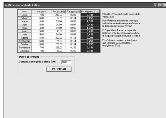
Figura 3. Interfaz de dimensionamiento eolico
