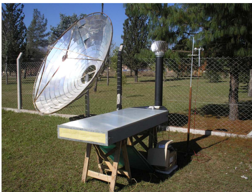
Figura 3: Secador solar ensayado, con chimenea y extractor eólico.
