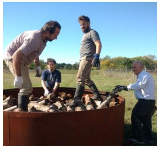
Acomodamiento y carga de la leña en el horno TPI
