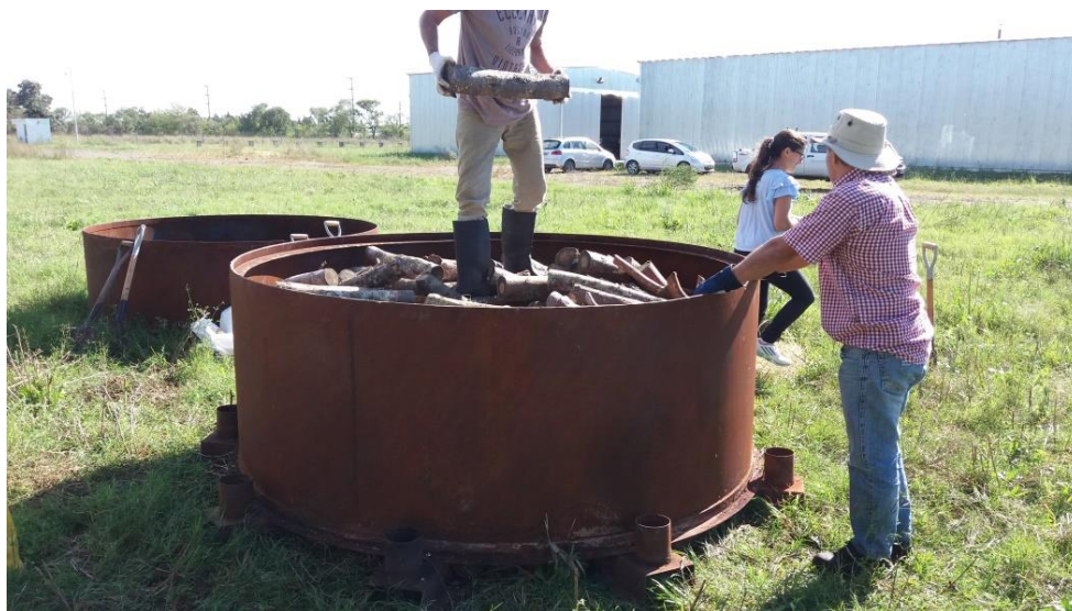
Figura 3. Horno TPI durante la fase de carga en la Estación Experimental.
