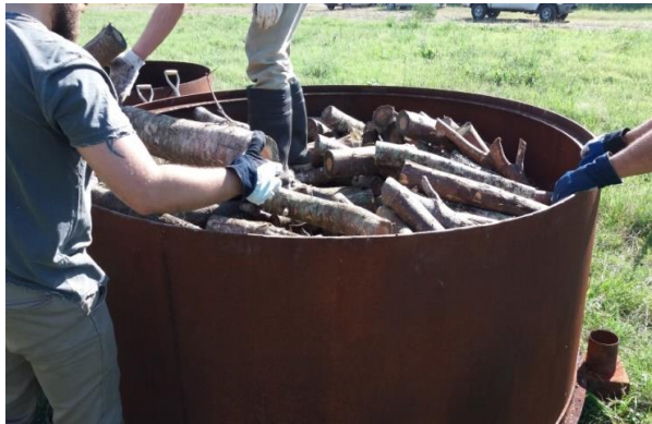
Acomodamiento y carga de la leña en el horno TPI
