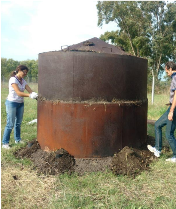
Sellado y puesta en funcionamiento del Horno TPI en la Estación Experimental
