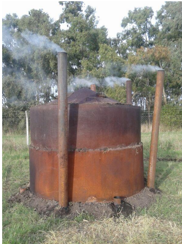
Figura 4. Horno TPI en funcionamiento en la Estación Experimental
