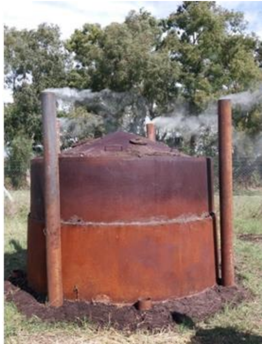
Sellado y puesta en funcionamiento del Horno TPI en la Estación Experimental
