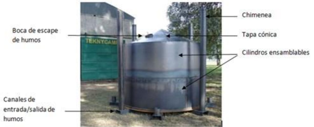
Figura 2. Diagrama de Horno metálico TPI
