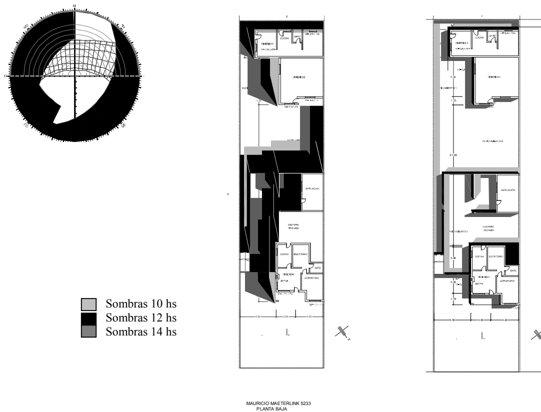
Figura 5: Estudio de sombras y asoleamiento de patios. La casa primigenia es la más próxima a la calle luego se sucedió la del fondo y actualmente están construyendo una en el medio del predio
