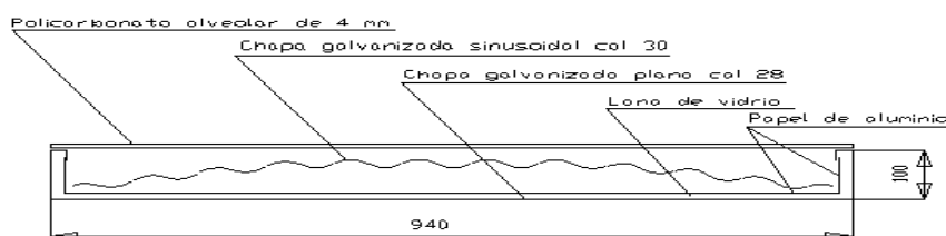
Figura 1: Vista en corte de un colector
