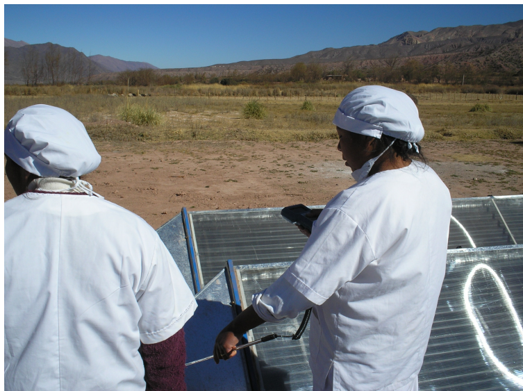
Figura 8: Medida de velocidad en un colector con anemómetro de hilo caliente
