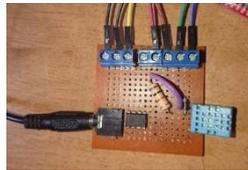
**Fig. 7.** Conexión de componentes en PCB perforada
