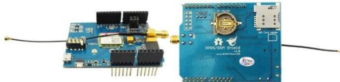
**Fig. 5.** SIM 800 GSM/GPRS Shield
