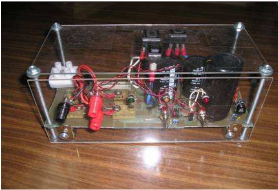
Figura 1. Carga electrónica desarrollada. Portable, replicable y fácilmente reparable. Coste inferior a 300 $ USA.
