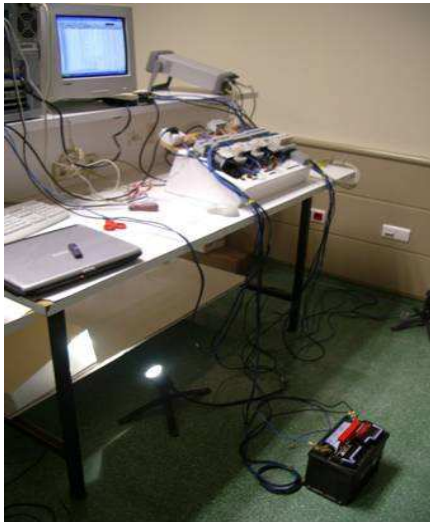
Figura 3. Bancada de pruebas para controladores de carga y baterías.
