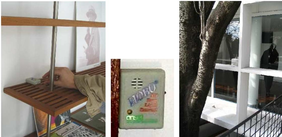
**Figura 4:** Detalle del microadquisidor de datos HOBOT y ejemplo de localización en el consultorio. A la derecha localización del resguardo meteorológico Hobo sobre el “brise soleil”.
