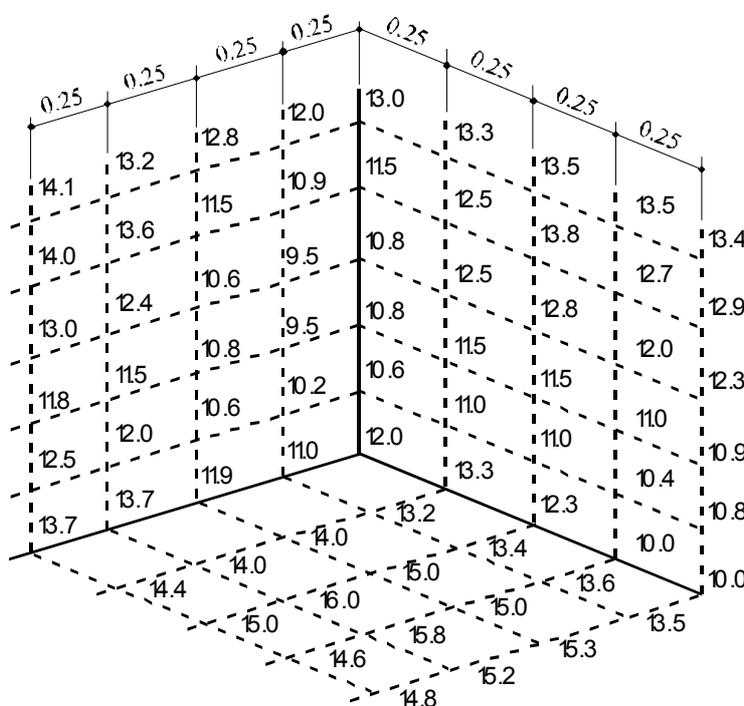
Figura 1: Esquema de relevamiento de datos en grilla para un encuentro característico de pared / pared / piso.
