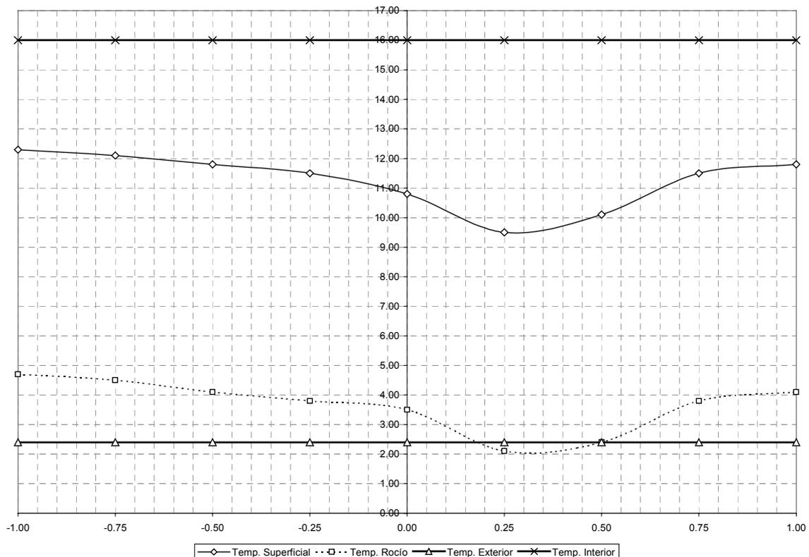
Figura 2: Variación de temperaturas (secas y de rocío) en una sección característica de muro.
