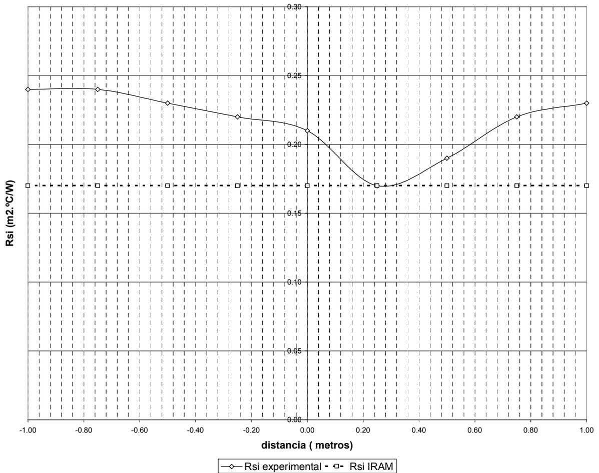
Figura 3: Variación de la resistencia superficial exterior respecto de la establecida por la norma IRAM 11603/99 en una sección característica de muro.
